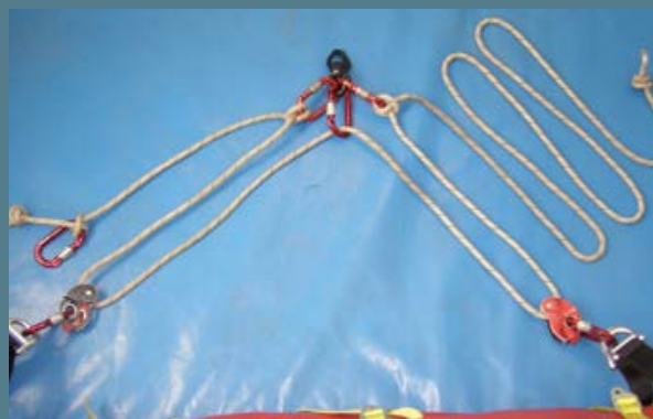
Opción 2. Sistema montado con antigiro y poleas monobloque.
