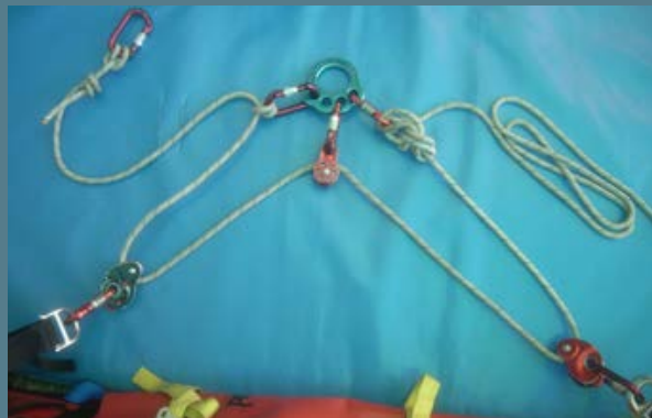
Opción 3. Sistema montado con antigiro y poleas monobloque.
