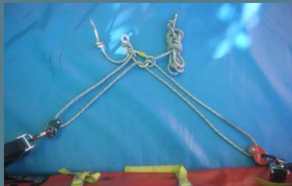
Opción 1. Sistema montado con poleas monobloque.
