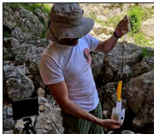
Diseño de la polea para colocarla en el interior del sifón. Fotos: Antonio J. Moreno.
