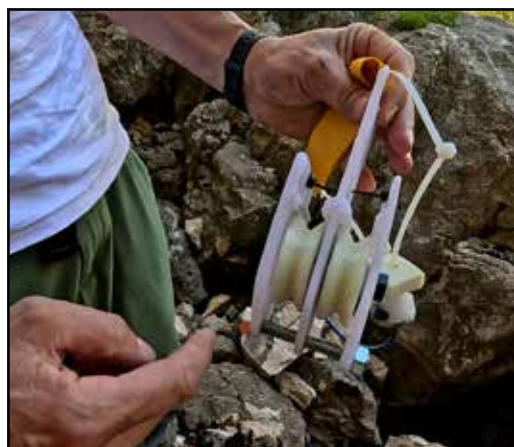
Diseño de la polea para colocarla en el interior del sifón. Fotos: Antonio J. Moreno.
