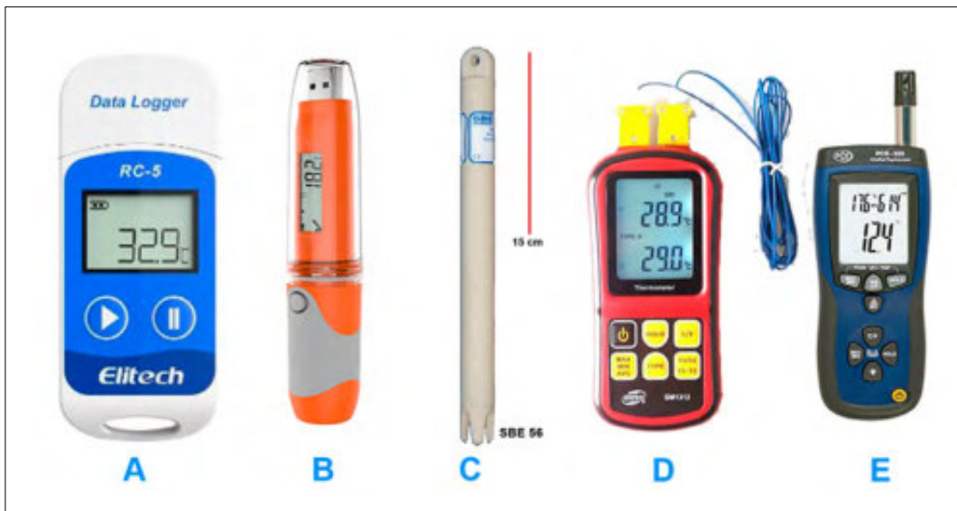
FOTO 2: EQUIPOS DE TEMPERATURA Y HUMEDAD
