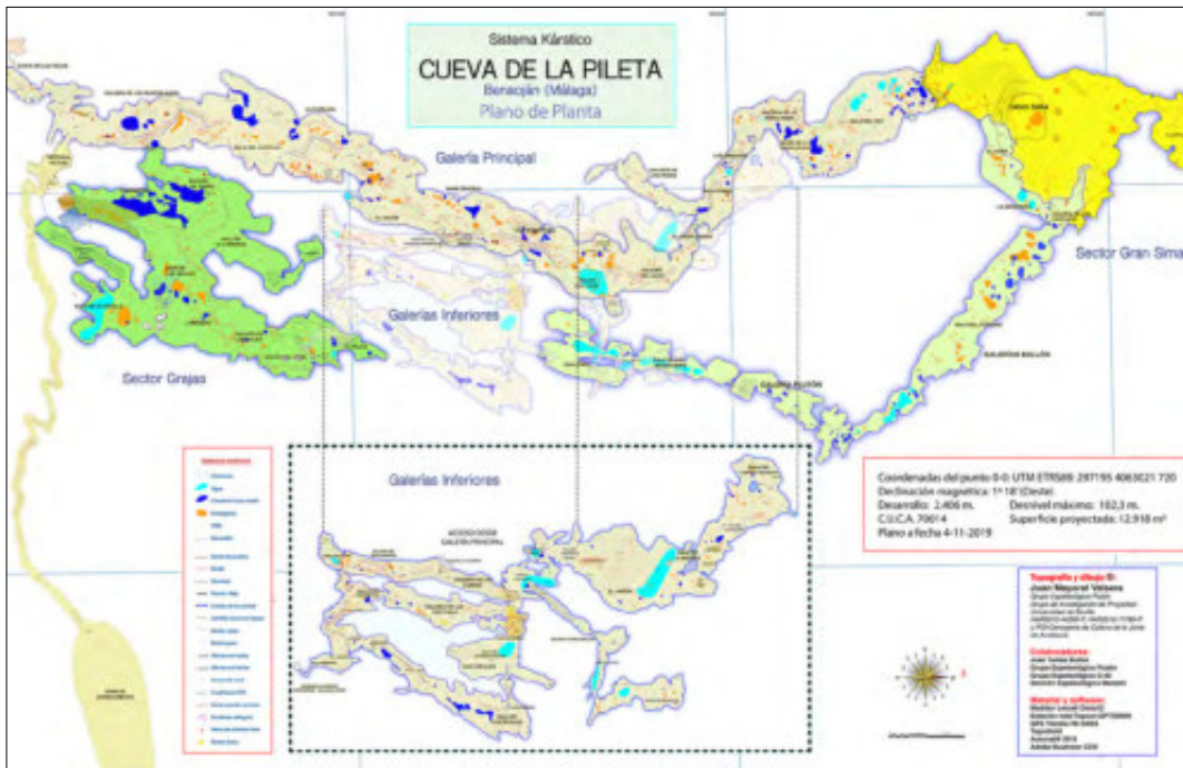
FIG. 10: Plano de Planta general, obtenido con el Sistema Híbrido y mostrando sólo las capas más comunes: morfología, escaleras, nombres, simbología, alturas, etc.
