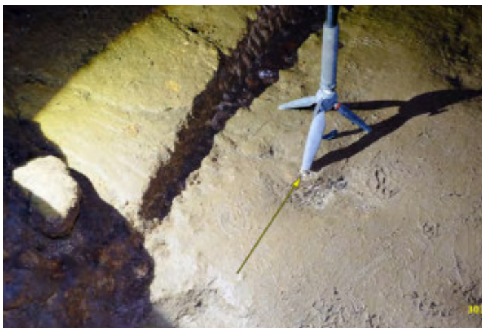
FIG. 5: Ejemplo de fotografía de situación de estación topográfica en el suelo para posterior utilización en su localización.
