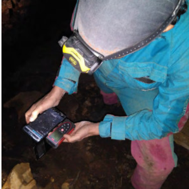
Disto X2 junto con la app de Topodroid, un buen tandem de trabajo.
