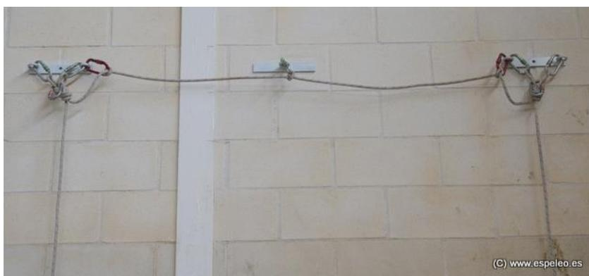
Al igual que en la instalación de la cabecera, colocaremos un nudo ocho con dos gazas, con dichas gazas lo más reducidas posibles. Bien en la placa de anclaje inferior, o si los anclajes están horizontales en la placa del lado de la dirección del pasamanos, pondremos un mosquetón en la placa por encima del anterior (utilizar un tipo de placas con diámetro suficiente para ello) al cual se le pondrá un nudo ballestrinque con una pequeña comba entre él y el nudo de cabecera.
