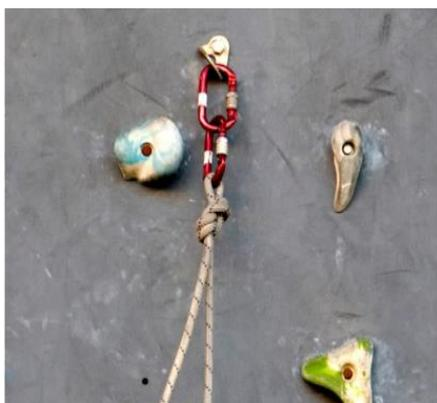
1) Montaje en rocódromo: El nudo utilizado para hacer el fraccionamiento será el ocho, y cuando las placas utilizadas sean reviradas, será obligatorio hacer una cadena con dos mosquetones para retirar el nudo de la pared.
