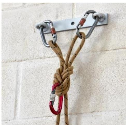
2) Montaje en espeleódromos: Se instalará doble anclaje, bien superpuesto o en horizontal, siendo el nudo utilizado para dicha instalación un ocho con dos gazas, con las gazas lo más reducidas posibles. Si se utilizan placas reviradas en paredes lisas, será obligatorio colocar una cadena con dos mosquetones para retirar el nudo de la pared. Es ineludible montar un mosquetón que pase por medio de las dos gazas o cosido al nudo para que el deportista pueda anclarse.
