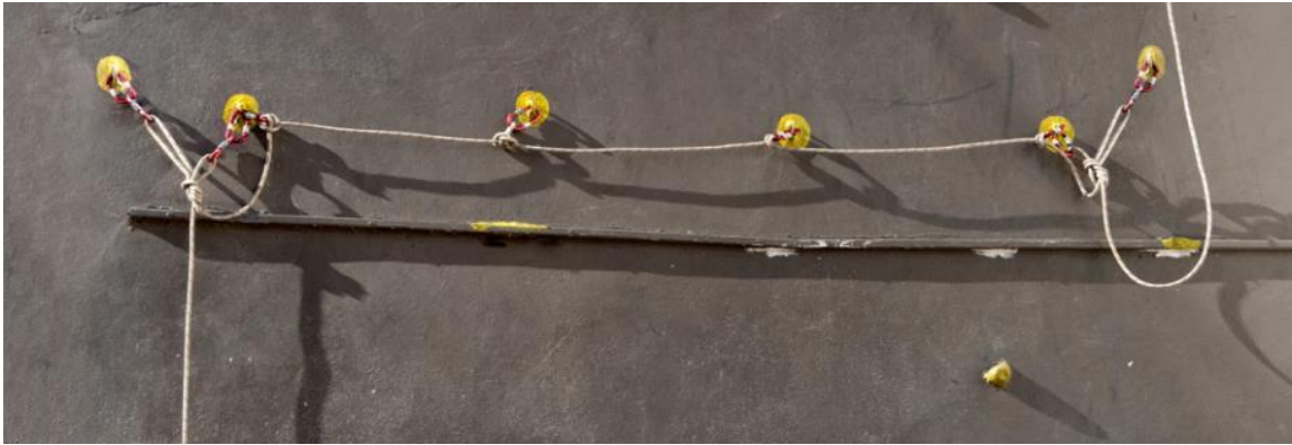
Ilustración 15. Pasamanos con puntos intermedios en espeleódromo
