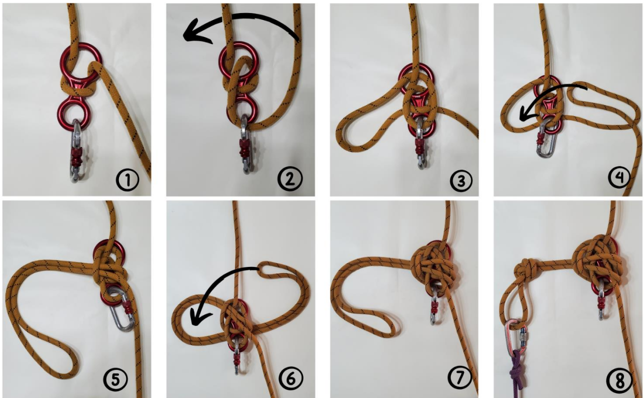
Ilustración 22. Llave de bloqueo del descendedor tipo ocho
