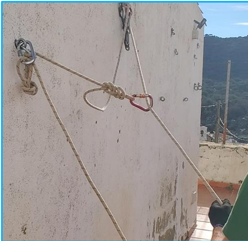
Ilustración 26. Montaje completo del desviador
