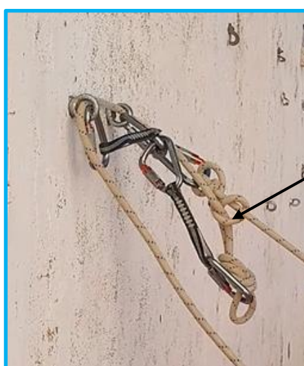
Ilustración 24. Cabecera con nudo dinámico y llave de fuga. Nudo de seguridad y reaseguro con cinta express a cabecera.
