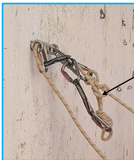
Ilustración 25. Cabecera con nudo dinámico y llave de fuga. Nudo de seguridad y reaseguro con cinta express a cabecera.
