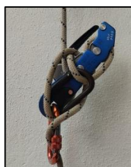
Ilustración 7. Llave de bloqueo finalizada correctamente (Modelo con palanca clásica orientada hacia arriba)
