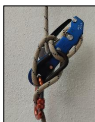
Ilustración 5. Llave de bloqueo finalizada correctamente (Modelo con palanca clásica orientada hacia arriba)
