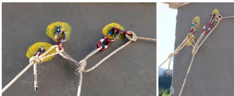
Ilustración 19. Montaje tirolinas espeleódromo
