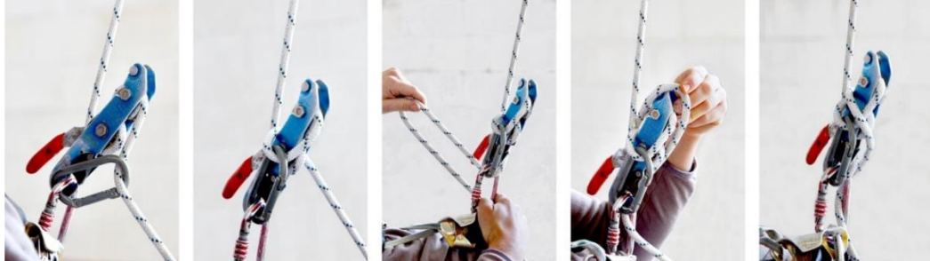
Ilustración 20. Pasos para la realización de la llave de bloqueo (Modelo clásico)
