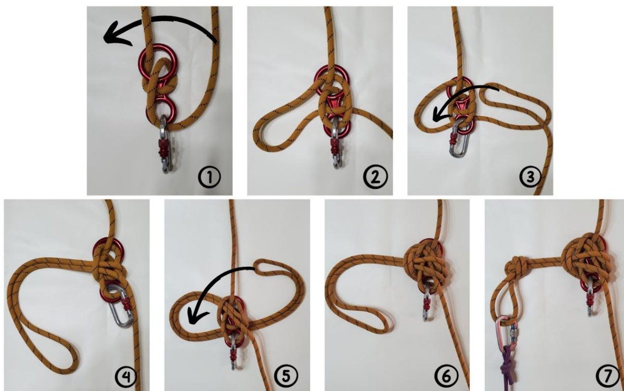
Ilustración 23b. Llave de bloqueo del descendedor tipo ocho. Montaje en vertaco
