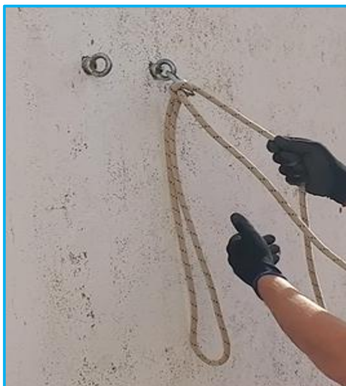
Ilustración 26. Gaza azocada contra el anclaje del desviador
